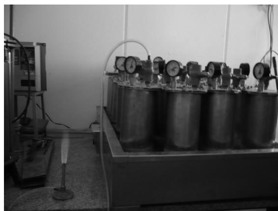
**Figura 2.** Disposición de reactores en baño termostático y quemador de biogás.
