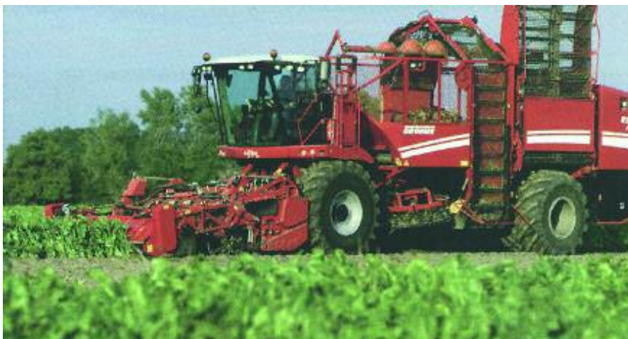
Fig. 30: Cosechadora autopropulsada de 6 líneas con tolva.
