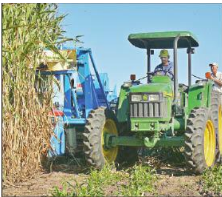
Fig. 36: Cosechadora de caña adaptada para la cosecha de sorgo.
