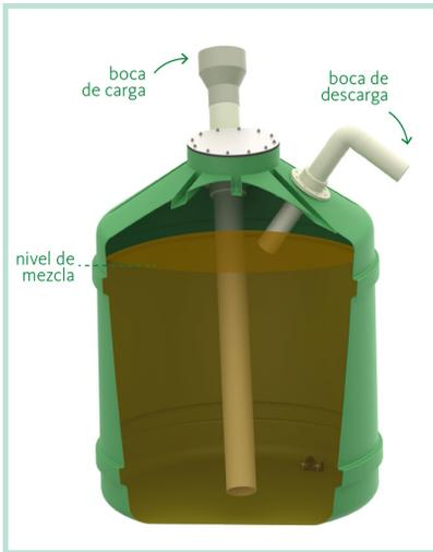
*La altura del caño de la descarga define el nivel del líquido en la cámara de digestión.*
