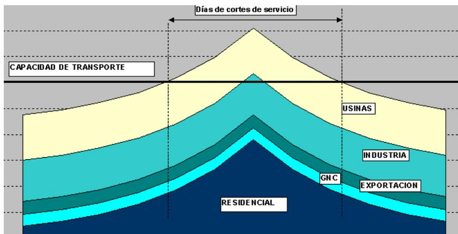
Saturación del Sistema de Transporte de Gas Natural
