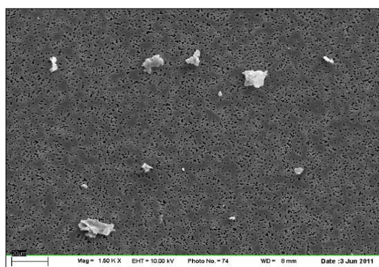
Figura 7: Micrografía de las partículas de la planta de acopio de trigo
