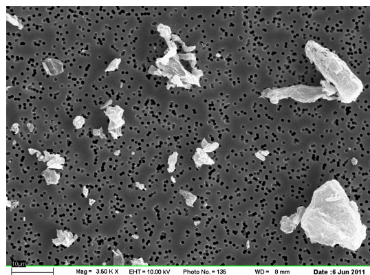
Figura 8: Micrografía de las partículas de la planta de producción de urea
