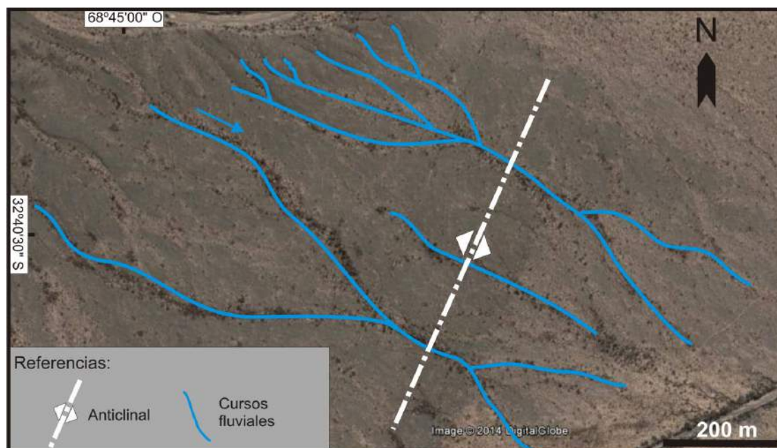
Figura 7: Anomalías en el drenaje por control activo de una estructura no aflorante (prolongación austral de la falla Barda Negra). Imagen base Google Earth.
