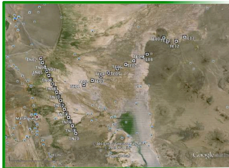
Fig. 2. La geometría del T-array. El T-array consiste de dos partes - TE, apuntando hacia este, y TN, apuntando hacia norte.
