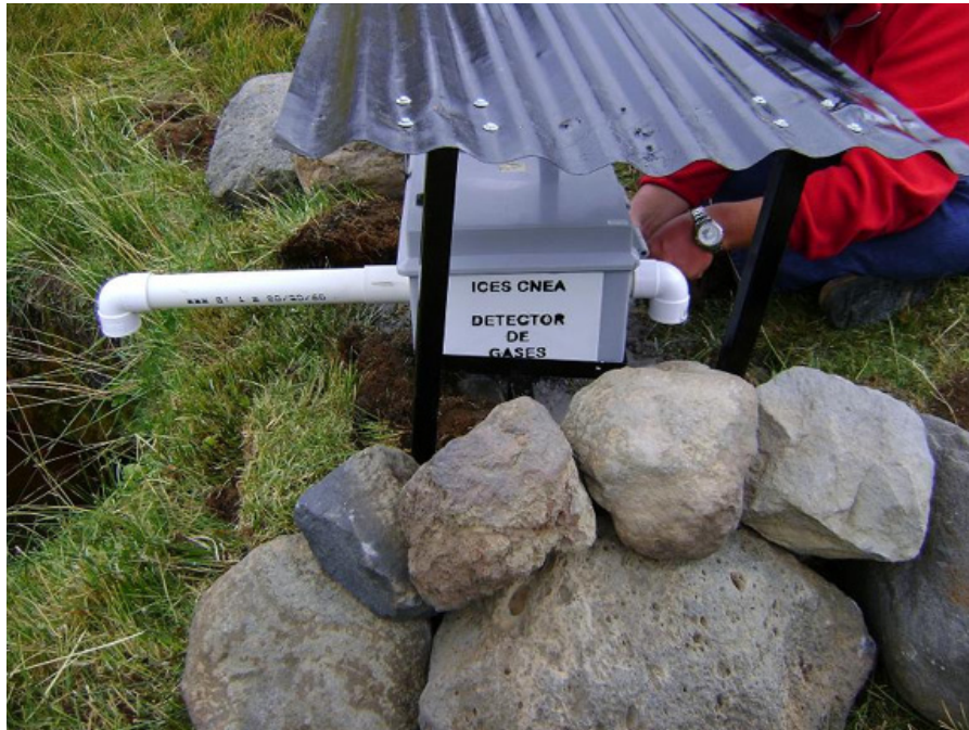
Figura 5: Montaje de uno de los monitores de gases en la ubicación "B"
