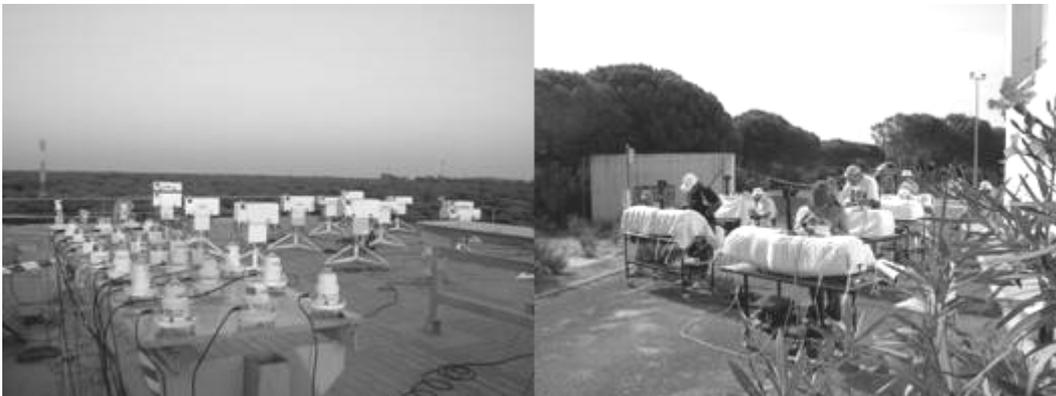
**Figura 4. Intercomparación y calibración de instrumentos Brewer y Dobson de la Red Mundial. (El Arenosillo, Campaña de verano 2007)**
